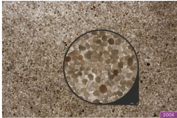
Figure 2.5 ASTM20-30 sand particles (Nouvelle du Littoral Co).
